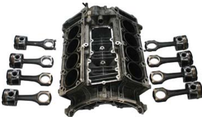
A motort tovább bontottuk, hogy eredeti célunk – kopásvizsgálat – végrehajtható legyen
